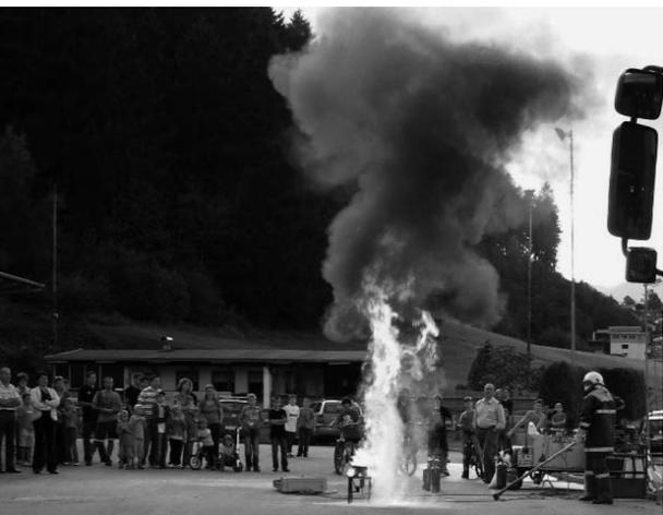
*Löscherversuch von brennendem Öl mit Wasser*
